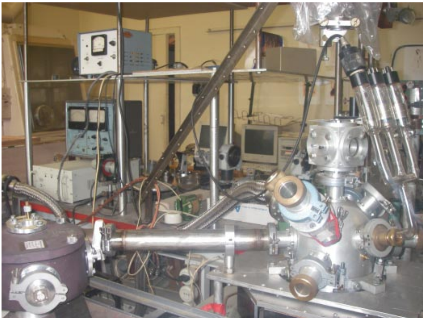
Так выглядит сделанный в ИСАНе прототип источника излучения для нанометровой литографии
